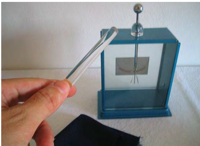
Cariche elettrostatiche prodotte sul vetro strofinato con la seta. (fonte: Sbalordiscienza)
