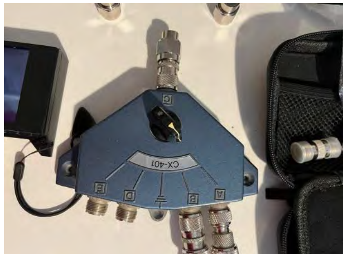
Collegamento del "tappo" SHORT, OPEN o LOAD al posto dell'antenna
