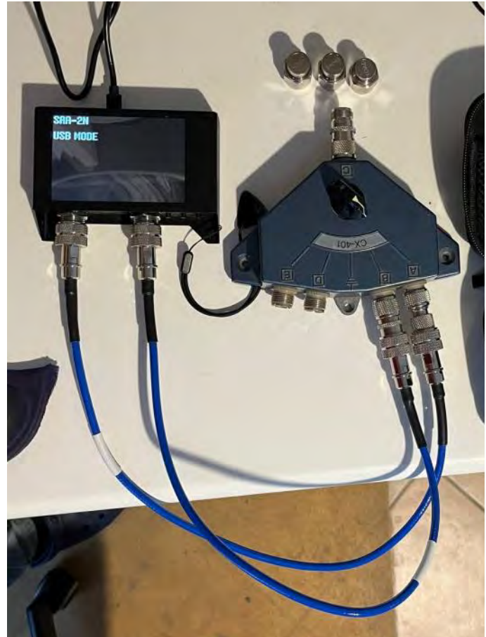
Collegamento di CH0 (simulatore di radio collegata all'antenna, in TX) su connettore porta A e di CH1 (simulatore di RX non collegato all'antenna, acceso o spento) su connettore porta B
