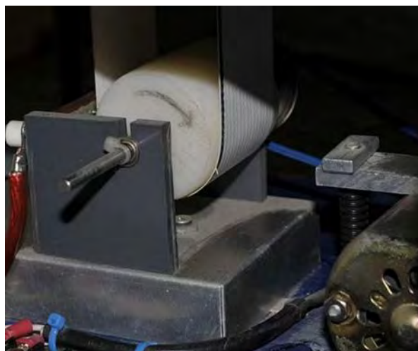
Esempio di base con il motore del generatore elettrostatico.
