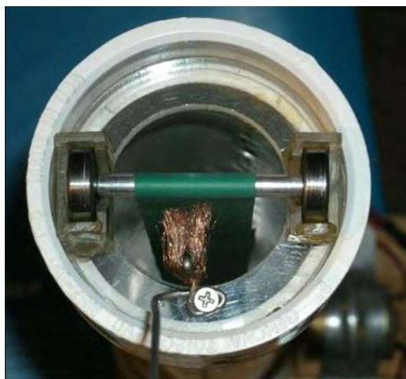
Il rullo superiore posto all'estremità del tubo in PVC.
